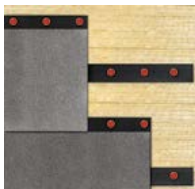
Рис. 3.44. Крепление полосы при устройстве однослойной кровли
