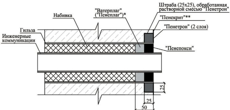
\*применяется при наличии активных течей на момент производства работ, при отсутствие течей необходимо использовать "Пенекрит"
